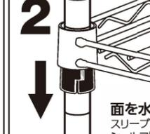
2 面を水平にします。スリーブのスレがないかを確認してシェルフ類を押し込みます。
