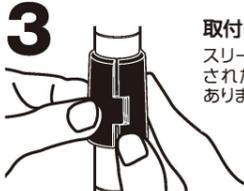
3 取付け完了! スリーブがきちんとセットされた状態でも隙間があります。
