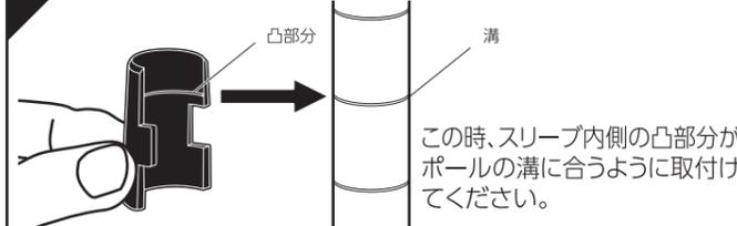
この時、スリーブ内側の凸部分がポールの溝に合うように取付けてください。
