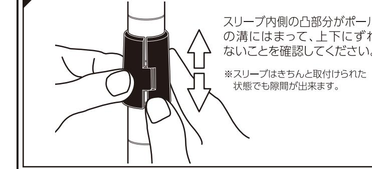
スリーブ内側の凸部分がポールの溝にはまって、上下にずれないことを確認してください。
