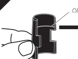
この時、スリーブ内側の凸部分がポールの溝に合うように取付けてください。
