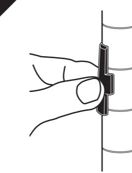
反対側も同様に、スリーブ内側の凸部分がポールの溝に合うように取付けてください。
