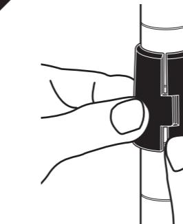
スリーブ内側の凸部分がポールの溝にはまって、上下にずれないことを確認してください。
