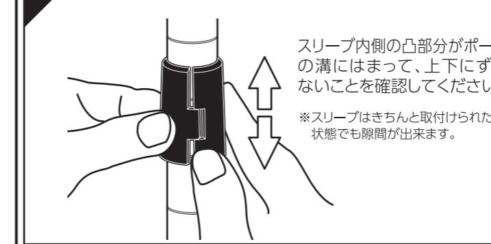
スリーブ内側の凸部分がポールの溝にはまって、上下にずれないことを確認してください。
