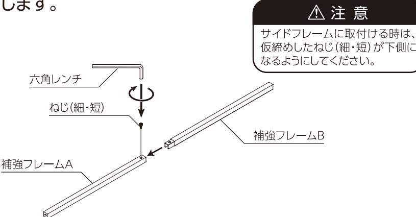
棚に連結フレームをはめ込み、ねじ(細・短)で仮締めします。
