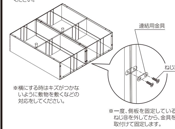
※一度、側板を固定しているねじ⑪を外してから、金具を取り付けて固定します。
