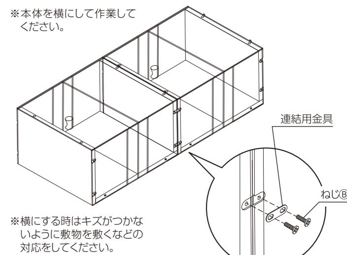
※一度、側板を固定しているねじ⑧を外してから、金具を取り付けて固定します。
