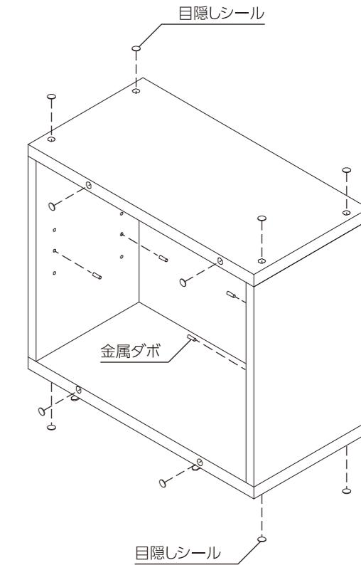
**5** 棚板を金属ダボにのせるように挿し込みます。
