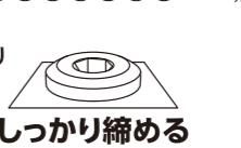
※ねじを最初からきつく締めると、他のねじの位置が合わなくなる、組立てができないことがあります。また、全体がゆがむ原因にもなるため、最初はねじを仮締めにして、最後に全てのねじをしっかり締めるようにしてください。
