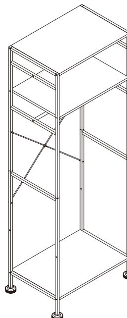
**3** クロスバーをクロスバー用ねじとナットで仮締めします。最後に仮締めした全てのねじをしっかりと締めます。
