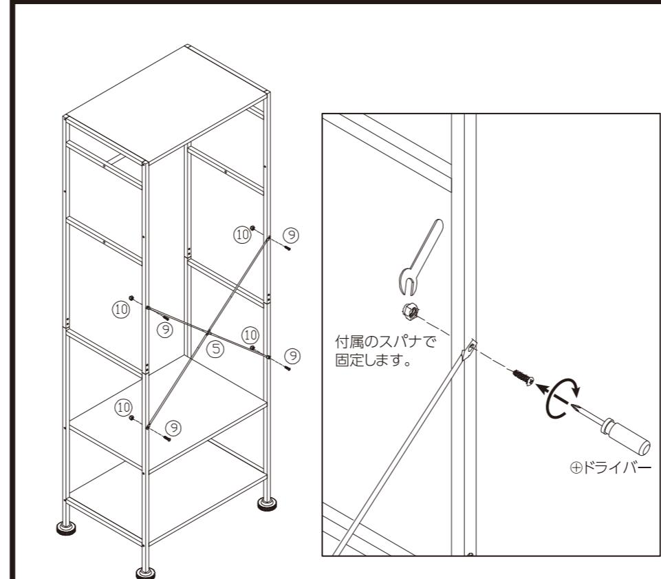
**4** 全ての組立て作業が終了したら、もう一度取付け箇所にゆるみがないか確認します。ゆるみがある場合は、しっかりと締め直します。
