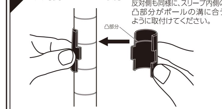
反対側も同様に、スリーブ内側の凸部分がポールの溝に合うように取付けてください。
