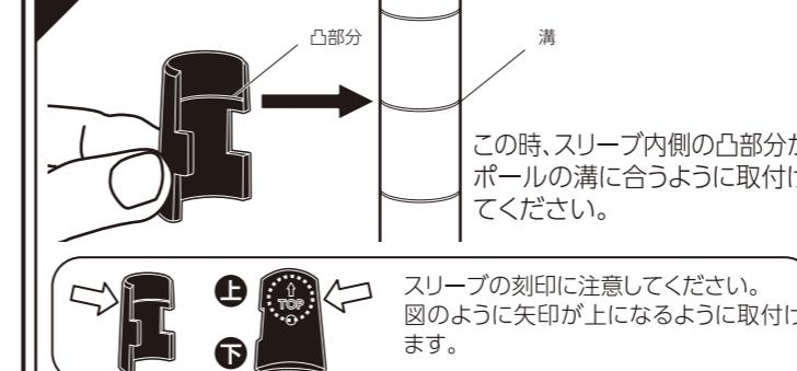
この時、スリーブ内側の凸部分がポールの溝に合うように取付けてください。
