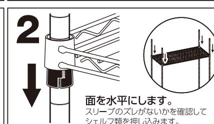
△注意 この時、スリーブ内側の凸部分がポールの溝に合うようにセットしてください。
