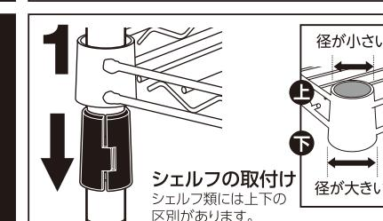
△注意 ①と同様に取り付けます。スリーブの凸部分が溝にセットされ、ズレないことを確認してください。
