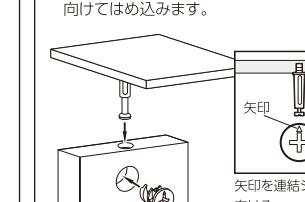
②④ドライバーで時計回りに固くなるまで締めつけます。
