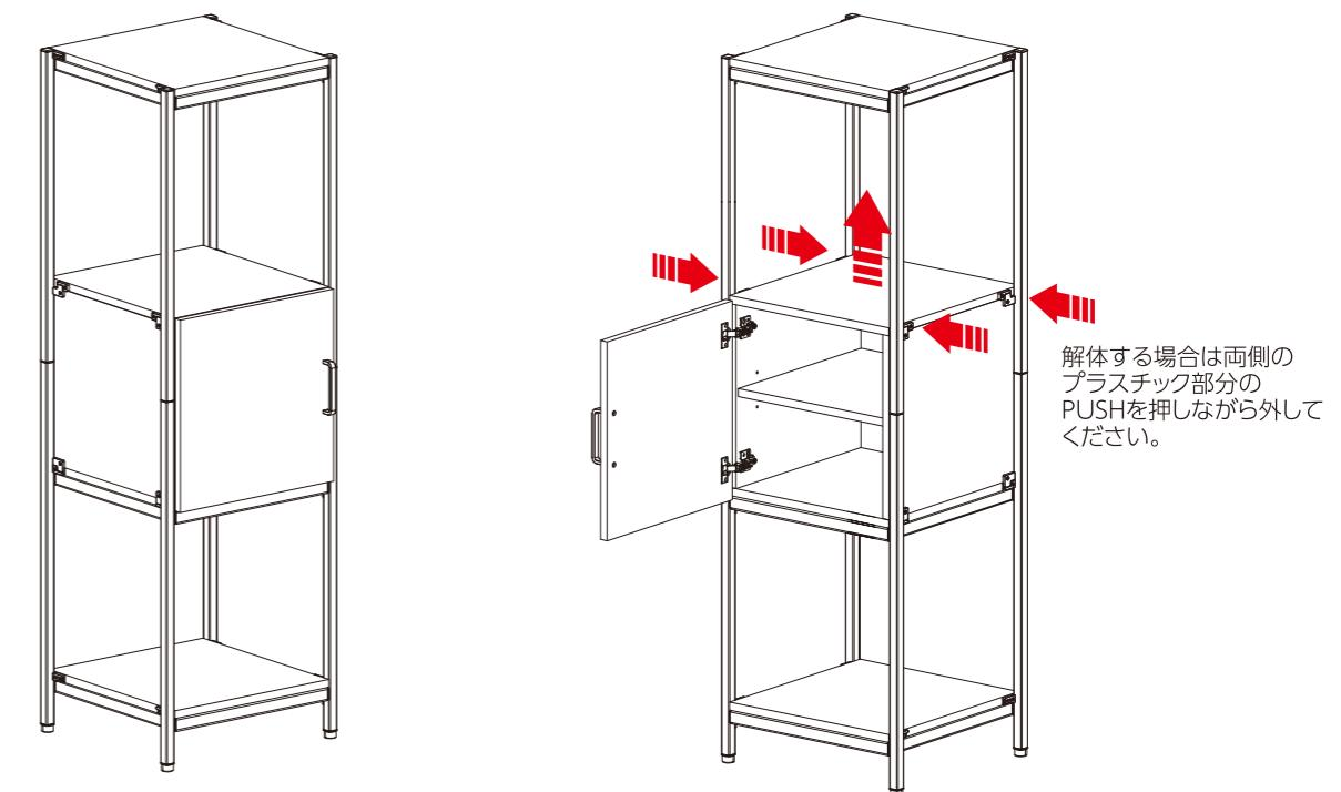
最上段に取付ける場合は、必ずウッドシェルフとフレームを取付けてください。
