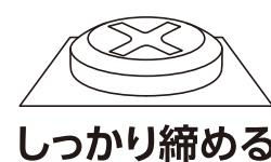
\*ねじを最初からきつく締めると、他のねじの位置が合わなくなり、組立てができなくなります。また、全体がゆがむ原因にもなるため、最初はねじを仮締めにして、最後にすべてのねじをしっかりと締めるようにしてください。
