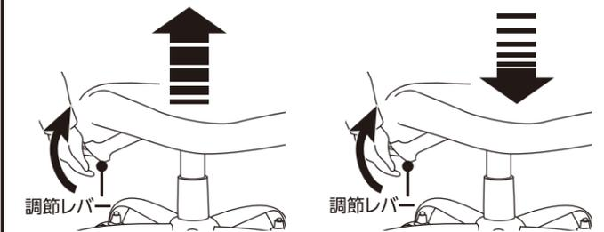
座面を上げる時も、下げる時も、**調節レバーは常に上に引き上げます。**
