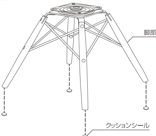
**2** 座部に取付けるためのねじ穴が回転盤(下部)と重ならないように調整します。
