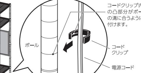
コードクリップ内側の凸部分がポールの溝に合うように取付けます。
