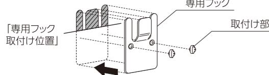
取付け部の3個の穴すべてに固定ピンを通して、根元までコインなどで押し込むか、かなづちなどで軽く打ち込みます。各固定ピンは打ち込み方向に違いがありますので1本づつ行います。各固定ピンの頭が浮いていないか確認し、浮きがある場合には最後までしっかりと押し込みます。
