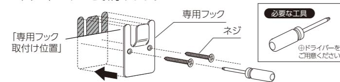
ネジの頭が飛び出ないよう、最後までしっかりと取付けます。
