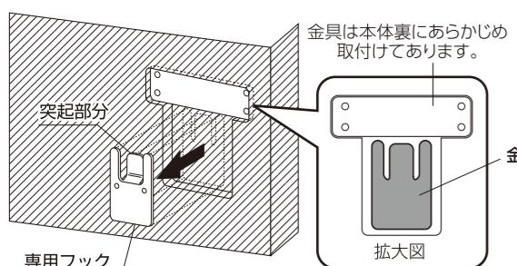
壁に接触したことを確認してから、下にスライドして専用フックを本体裏側の金具に引っかけます。
