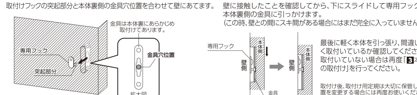
壁に接触したことを確認してから、下にスライドして専用フックを本体裏側の金具に引っかけます。
