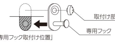
取付け部の3個の穴すべてに固定ピンを通して、根元までコインなどで押し込むか、かなづちなどで軽く打ち込みます。各固定ピンは打ち込み方向に違いがありますので1本づつ行います。各固定ピンの頭が浮いていないか確認し、浮きがある場合には最後までしっかりと押し込みます。
