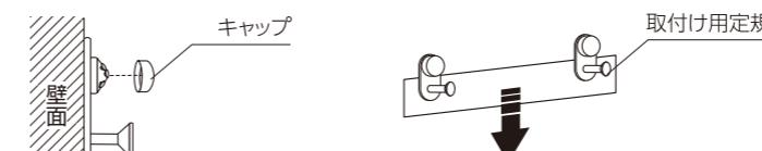
取付けたら、取付け用定規をゆっくり上へずらして取外します。
