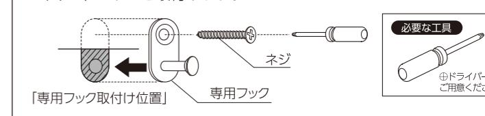
ネジの頭が飛び出ないよう、最後までしっかりと取付けます。
