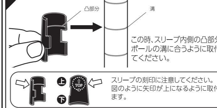
この時、スリーブ内側の凸部分がポールの溝に合うように取付けてください。
