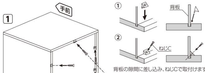
背板の隙間に差し込み、ねじCで取付けます。
