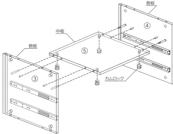
※カムロック取付け方の詳細は、「カムロックの取付け方」を参照してください。
