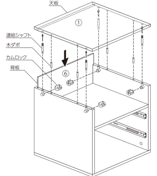
※連結シャフトとカムロック取付け方の詳細は、「連結シャフトとカムロックの取付け方」を参照してください。
