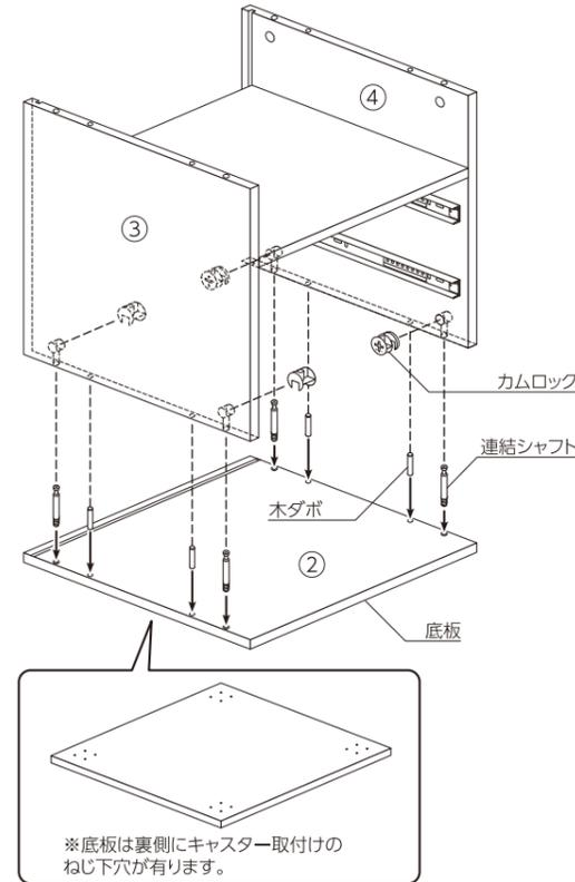
※連結シャフトとカムロック取付け方の詳細は、「連結シャフトとカムロックの取付け方」を参照してください。
